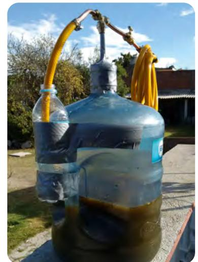
Ejemplo de biodigestor construido por los alumnos durante el proyecto
