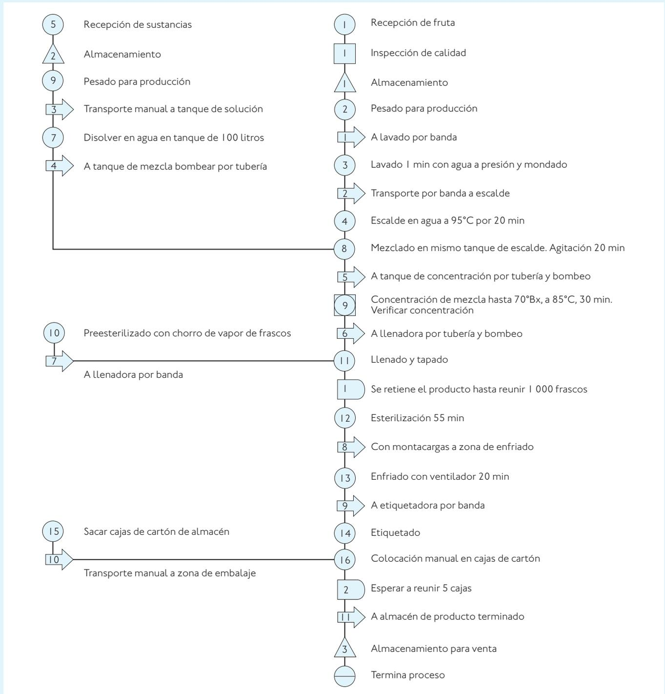
Figura 3.15 Diagrama de flujo de proceso.
